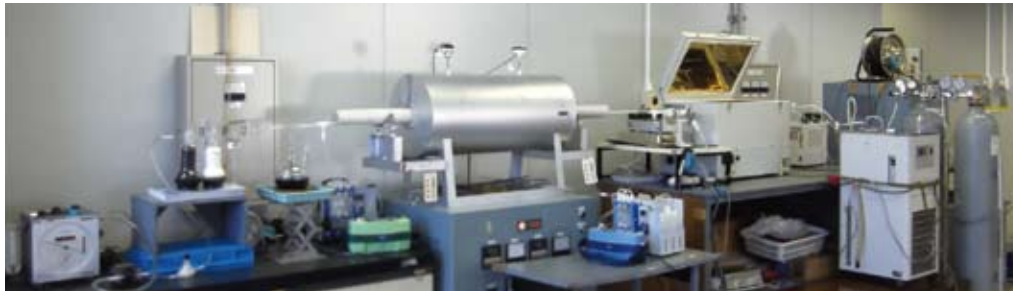
排出ガス中の水銀除去に関する実験装置
