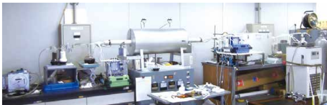
ガス状水銀の吸着・反応処理実験装置(全体図)
