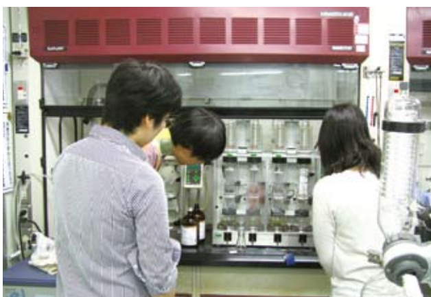
土壌試料からダイオキシン類をソックスレー 抽出している様子
