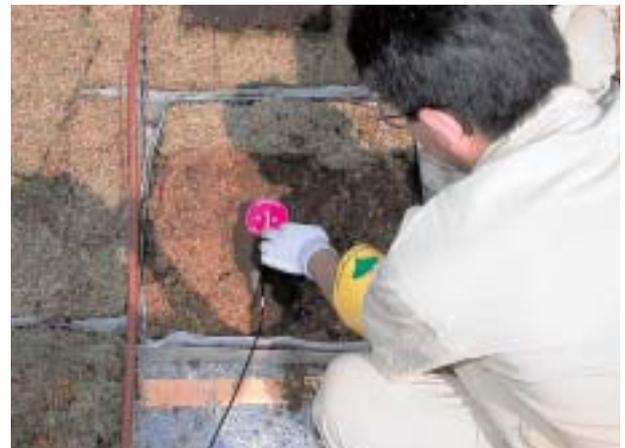
測定器（熱流板）の設置状況（芝区）
