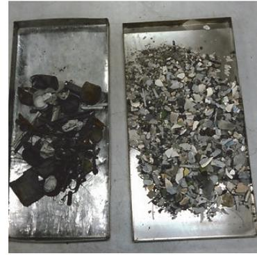
写真1 A工場不燃物 (左: 金属系、右: ガラス陶磁器系)
