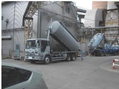
飛灰運搬車両（密閉式）
