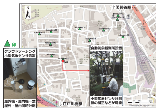
図2 調査地域及び調査で使用了計測器の写真。小日向住宅11箇所の屋内外に気象計を設置した。
