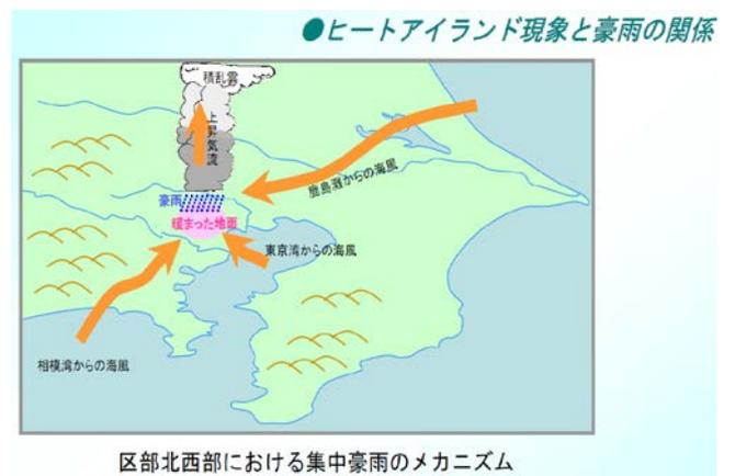
図 6. ゲリラ豪雨発生メカニズムの一例
