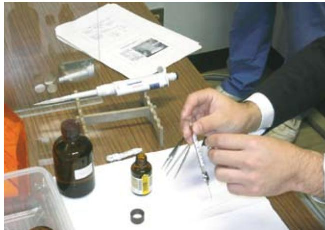
③捕集したアスベストを、測定のために薬品を使い前処理を行う実習をしました。
