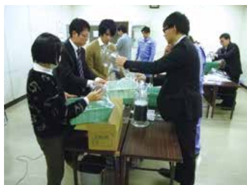
三点比較式臭袋法による悪臭測定
