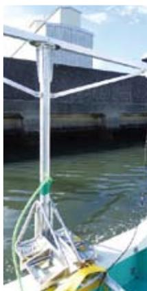
音響測深機の上部にGPSを設置するとともに、パソコンに地図情報を取り込み、位置情報を把握する。
