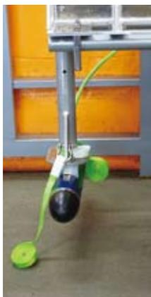
地上でのトレーニングで実際に取り付けられた音響測深機。青と黒の楕円形の部分が本体
