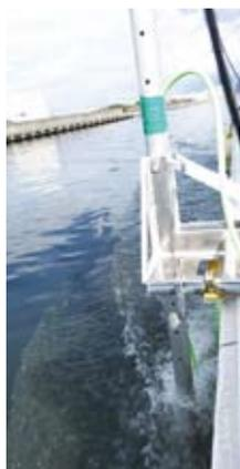
計測中の音響測深機の様子。本体部分は海中に沈められる。
