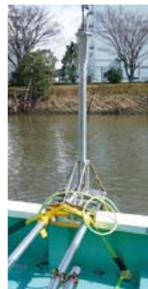
調査船に取り付けをする際には、水流で落ちないように本体はベルトで調査船に固定する。
