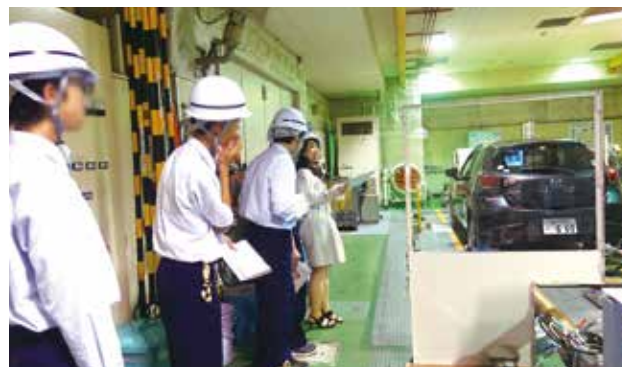
小型車の排出ガスを測定する装置の説明
