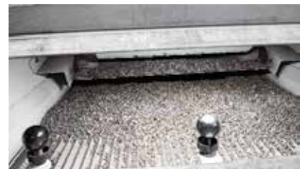
写真3 エアテーブルによる比重選別の様子
