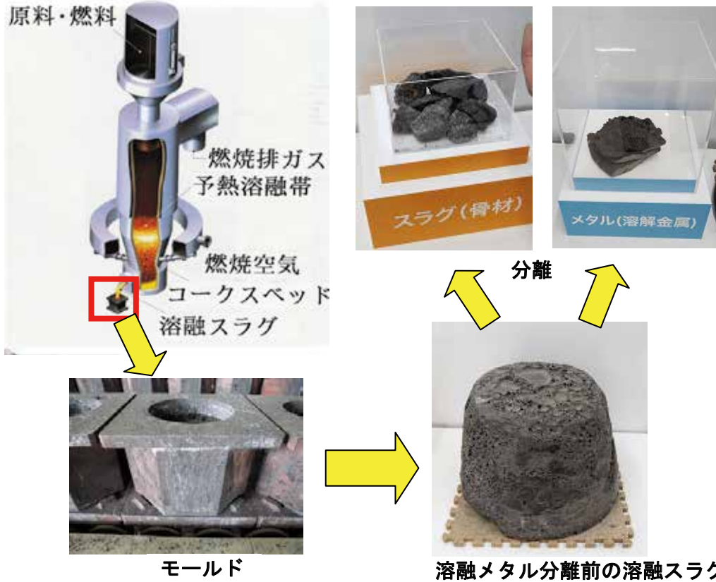
図2 溶融炉の構造と溶融メタル、溶融スラグ
