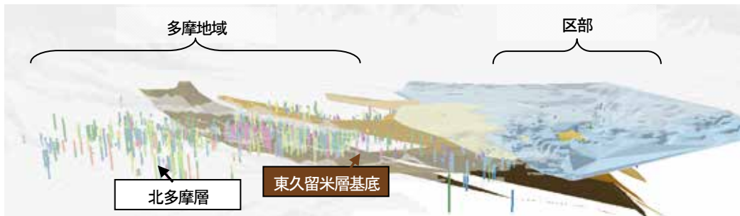
図2 都内全域におけるスクリーン深度と帯水層との関係（南方向から見た地盤断面）
