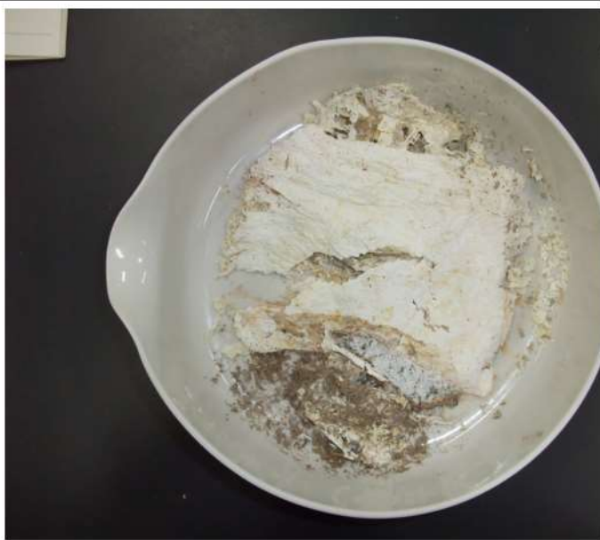
ビニール・合成樹脂類 (上段：灰化前、下段：灰化後)
