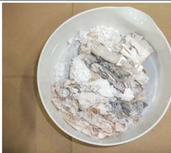
上段：厨芥類（灰化後） 下段：紙・布類（灰化後）
