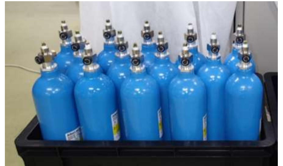
水素吸蔵合金(タンク)
