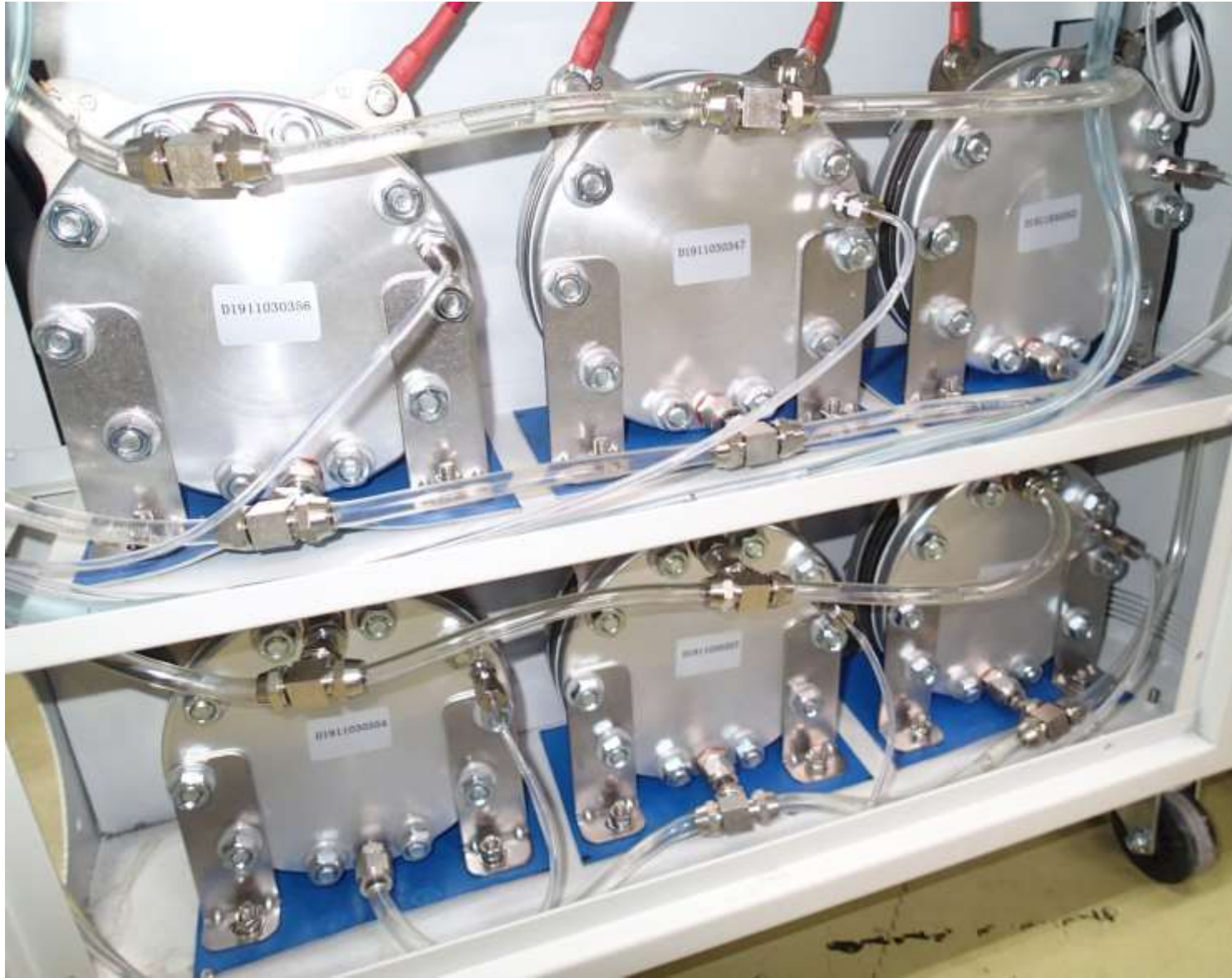
水素製造装置の心臓部
