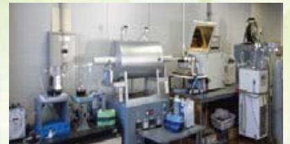
▲ ガス状水銀における吸着・反応処理実験装置
