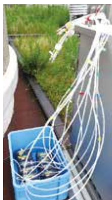
【写真3】アルデヒドをサンプリングする機器
