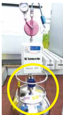
【写真1】設置したキャニスター(下側の丸いもの)
