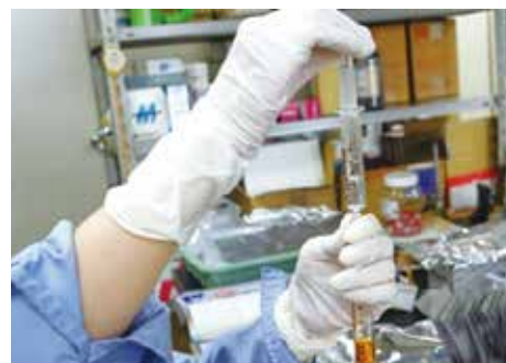
【写真5】溶媒でカートリッジからアルデヒドを抽出している様子
