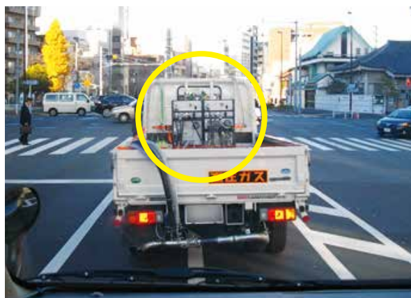
【写真4】 PEMS車両設置状況
