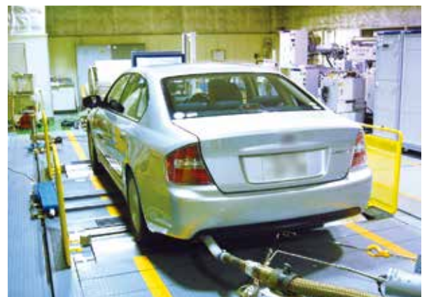
【写真2】小型車用排出ガス計測設備
