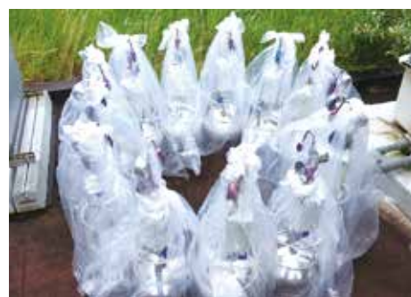
【写真2】24時間採取のために使用した12個のキャニスター
