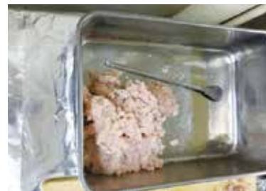
【写真3】ミンチ状になった可食部。機器で分析する際は、さらに溶媒による抽出などの前処理を施す。
