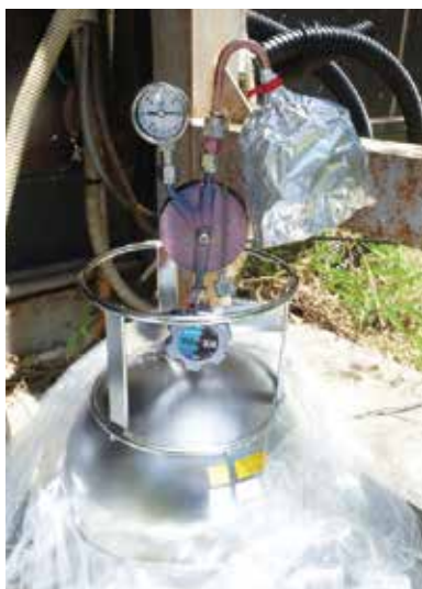
【図3】大気試料採取器材の例 《流量調整器及び採取容器(キャニスター)》
