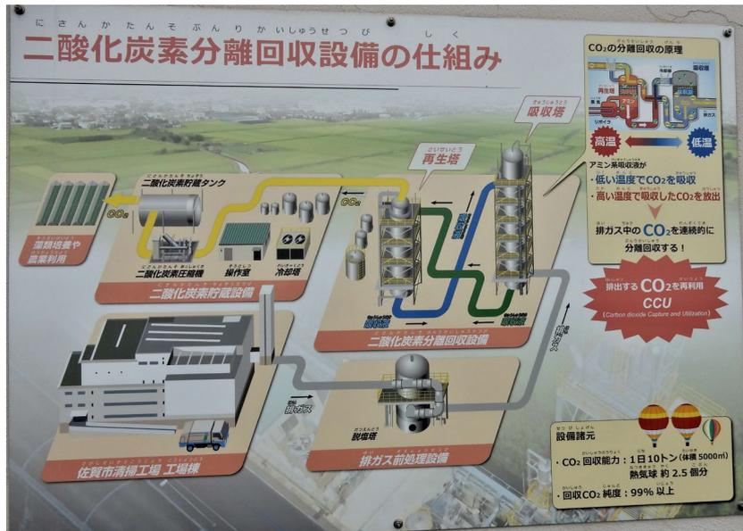
図1 分離回収システムフロー（工場案内板より）
