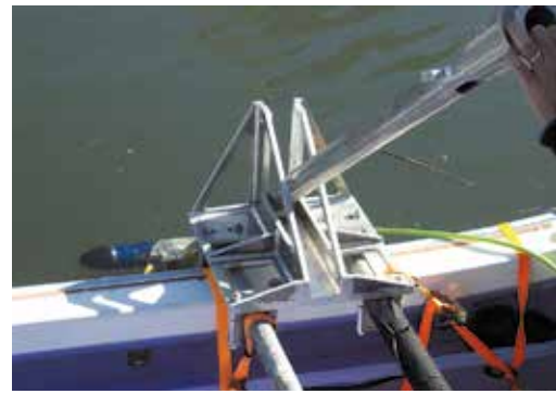
写真1 船右舷に取付けた音響測深機
