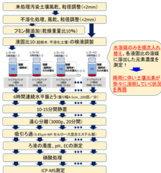
図1 シリアルバッチ型溶出試験方法の操作フロー
