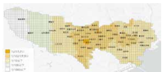
図5 都内の高リスク物質の大気拡散モデルによる予測濃度の 大気管理参考濃度との比
