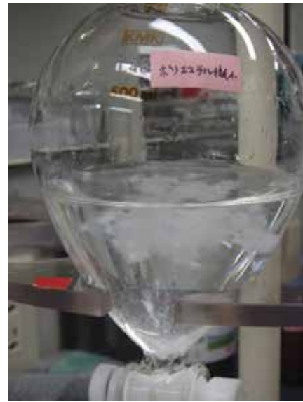
図2 布地表面を刃物で削り取り、繊維状物質を純水に分散させた試料 試料量 ナイロン球状 : 0.213g(11 粒) ナイロン繊維状 : 0.208g ポリエステル繊維状 : 0.210g
