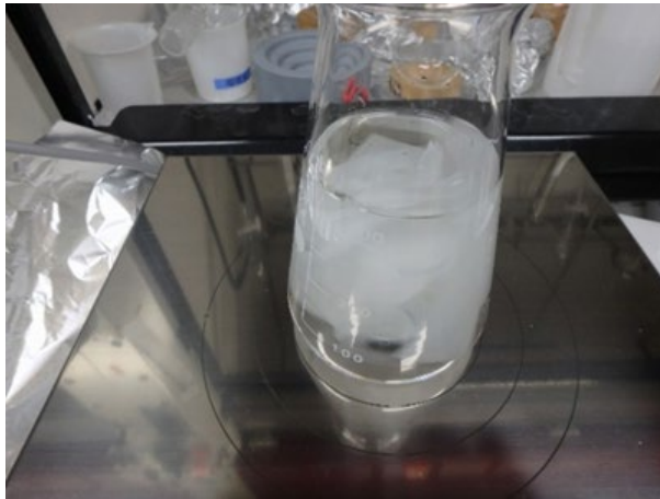
図1 スターラーによる洗濯を模した負荷処理 (5cm 角の試験片は攪拌終了後、取り除く)
