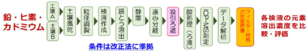
図1 試料調製・溶出試験の操作フロー
