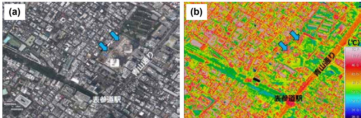
図2 北青山三丁目再開発地とその周辺の(a)可視画像と(b)地表面温度(°C)(8月2日13時30分). ヘリコプターによる撮影・計測. 放射率は一律に1と仮定. 緑化予定箇所(👉)の温度は概ね40°C以上で高温である.
