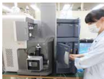
【図2】高速液体クロマトグラフ飛行時間型質量分析計(LC/QTOF-MS)と筆者
