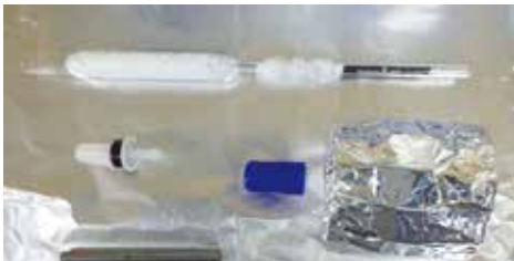
大気捕集材の例 （上：除湿管と活性炭系吸着剤、左下：シリカ吸着剤カートリッジ、右下：ディスク型固相吸着剤）
