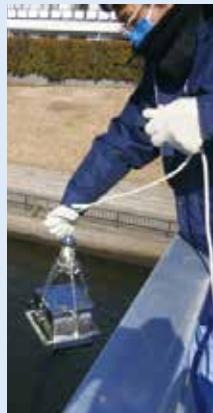
紐を付けた採水（泥）器を橋の上から川に落とし採水します。引き上げる際には橋の軸体にロープが接触しないよう注意を払います。また、観測地点によっては潮の満ち引きの影響を受ける場合があるため、事前に採水可能な時間帯を調べておく必要があります。
