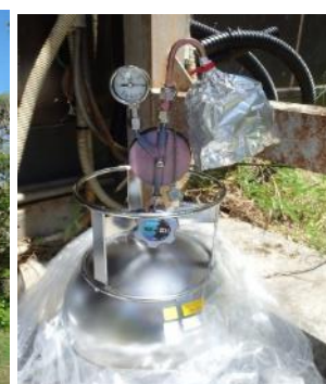
大気試料の採取例 流量調整器及び 採取容器/キャニスター
