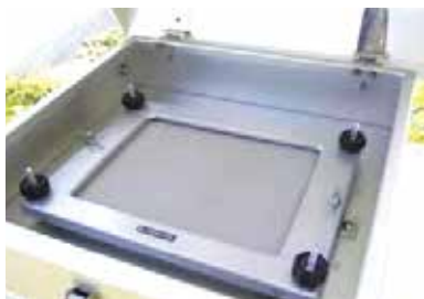
大気試料吸引後(約1,440m 3 )のろ紙(石英)
