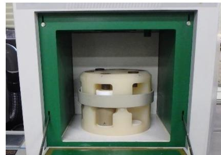
マイクロウェーブ (圧力容器分解装置)
