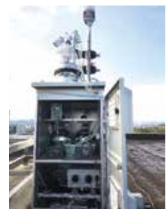
【写真5】様々な採集法による大気中化学物質の採取(左:吸着管採取、中:キャニスター採取、右:風向別VOC採取)
