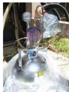
【写真5】様々な採集法による大気中化学物質の採取(左:吸着管採取、中:キャニスター採取、右:風向別VOC採取)
