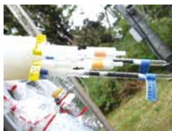
【写真5】様々な採集法による大気中化学物質の採取(左:吸着管採取、中:キャニスター採取、右:風向別VOC採取)
