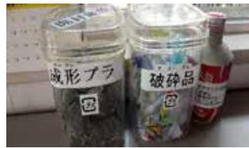
破碎成形設備による成形プラと破碎品
