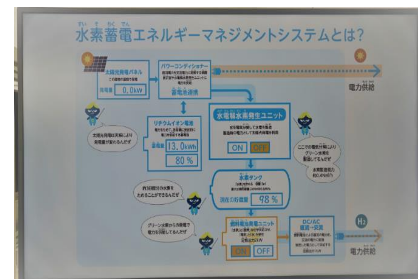
見学者用水素蓄電設備の稼働状況モニター
