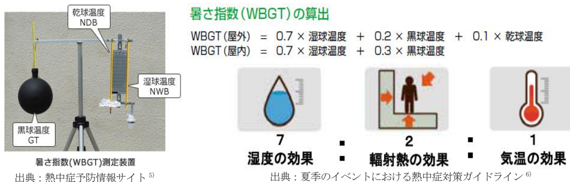
図 1 WBGT の測定装置と算出
