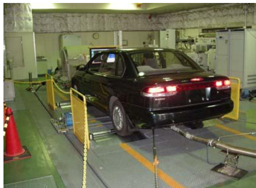
シャシダイナモによる自動車排出ガス測定
