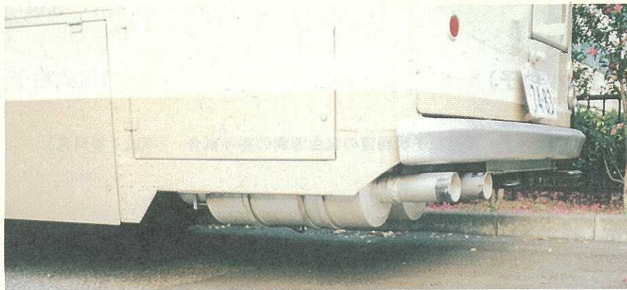
写真-2 DPFシステムを装着した実験車
