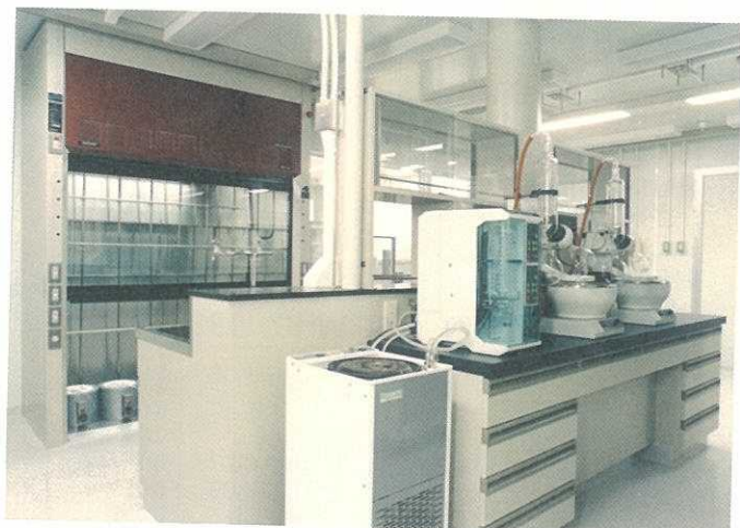
写真1 低濃度試料処理室 —中央実験台とウォークインドラフト—
