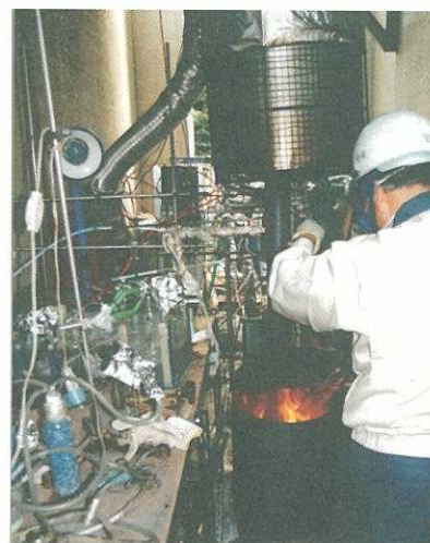
家庭用焼却炉のダイオキシン類生成実験
