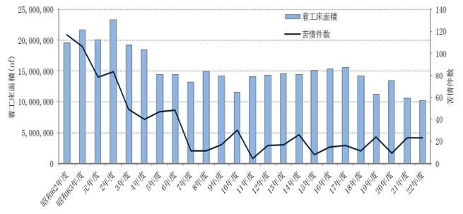
図10 着工建築物床面積と杭打ち機等に係る苦情件数の関係
