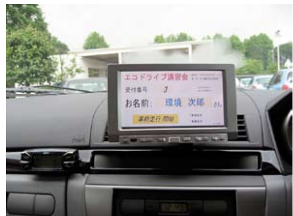
図5 試作システムを車に装着したところ ＜試作システム（エコドライブ講習会用）の一例。 講習会参加者の運転の評価用として活用した例＞
