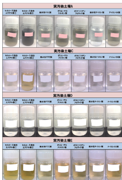
図4: フィルター材質変更試験から得られたろ液の写真 ろ液に濁りが認められた試料に関しては、ろ過に用いたフィルター材質の違いによって明らかにその濁りの程度が変動した。
