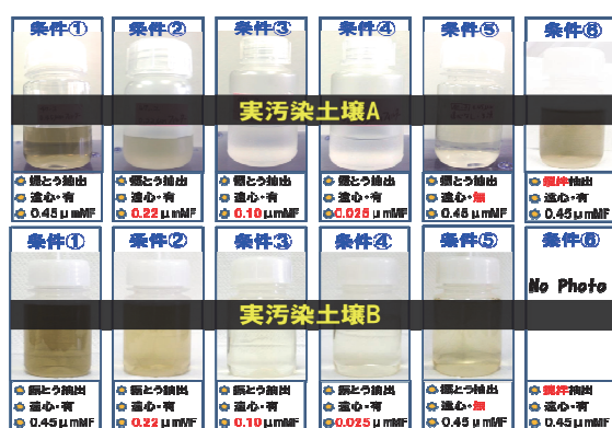
図2: 操作条件変更試験から得られたろ液の写真 実汚染土壌 A、B 共に、抽出法、遠心分離の有無、ろ紙の孔径など一部の操作条件の変更に伴いろ液の濁りが明らかに変動した。
