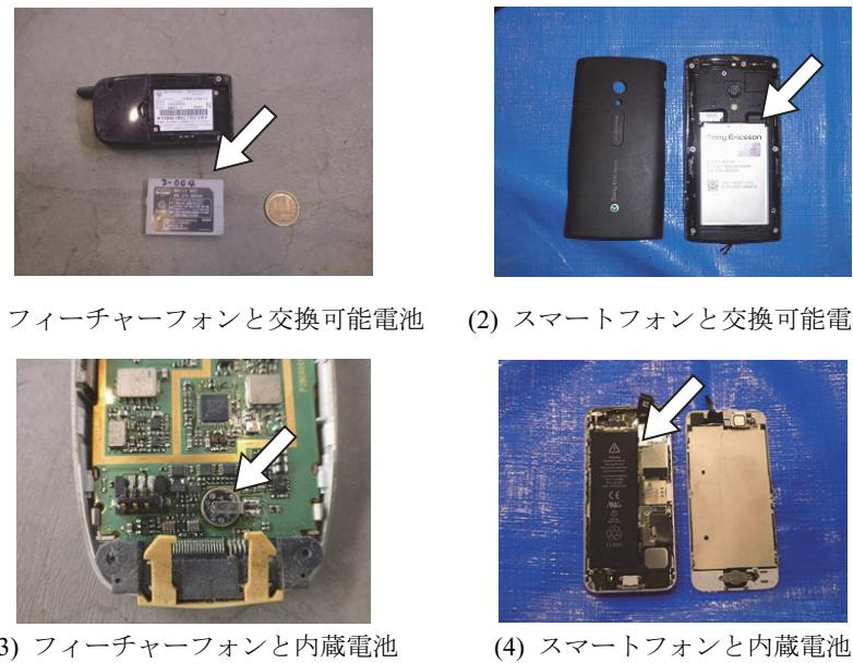
図 1 携帯電話と交換可能電池／内蔵電池（矢印が電池）
