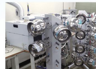
▲ 可同时检测挥发性有机化合物和氟利昂类物质的分析系统
