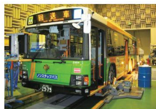
▲ 用于大型车辆的底盘测功机
