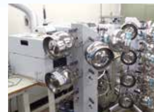
▲揮発性有機化合物(VOC)とフロン類の両方に対応した分析システム
