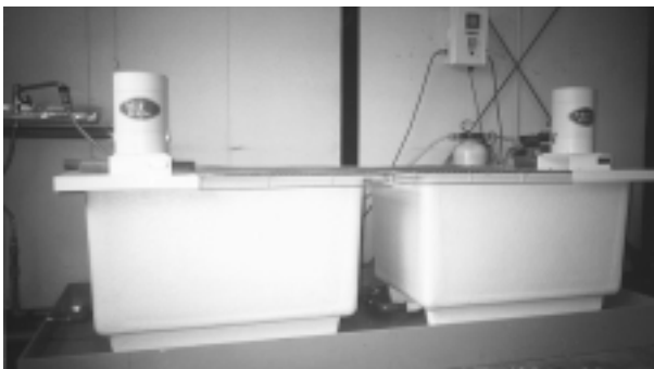
写真3 丸子水質自動測定室内に設置したFRP製水槽
