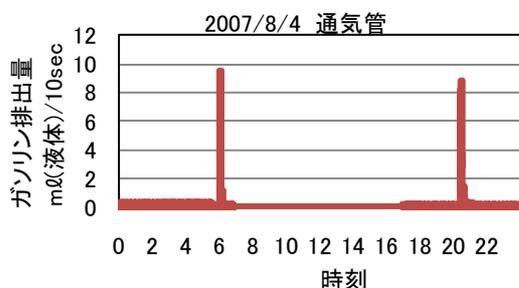
図 2 通気管からのガソリン蒸気測定結果例
