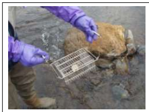
図2 水温ロガーの設置
